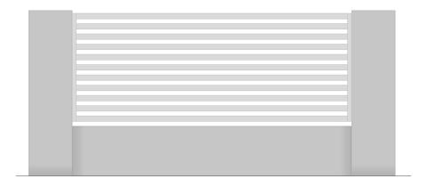
Die Oberkante des Zaunfeldes wird individuellabgeschlossen, jedoch in der Regel und am häufigstenkurz unter der Pfostenhaube. Die Zaunfelder können sowohl in Mauerpfosten u. Ä. als auch in den Stahlpfosten (Aluminiumpfosten) verankert sein.
